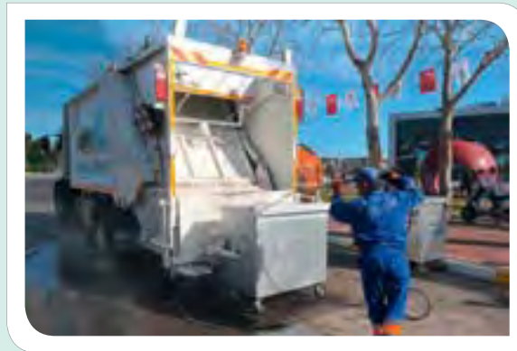
Çöp Konteynırının Yıkanması İşlemi
